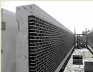
Рис 3. Производство крупногабаритных железобетонных панелей "GreatWall" (г. Филадельфия, США).
