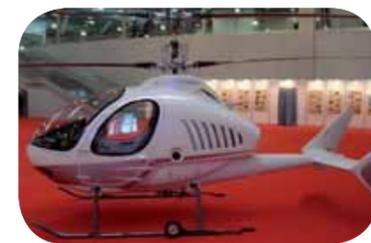
стема управления решительно проще и напоминает руль автомобиля - куда повернул, туда и полетел. На снимке вы видите вертолет "Беркут". Двухместный. Соосный. Имеет автомобильный двигатель. От "Лады" - подешевле, от "Тойоты" или "Субару" подороже. Развивает скорость до 300 км/ч и поднимается до 3 километров (хотя лично мне было бы достаточно 150 км/час и подъема до 100 метров). Это машина русского производства. Стоит такой аппарат 50 тысяч долларов.
